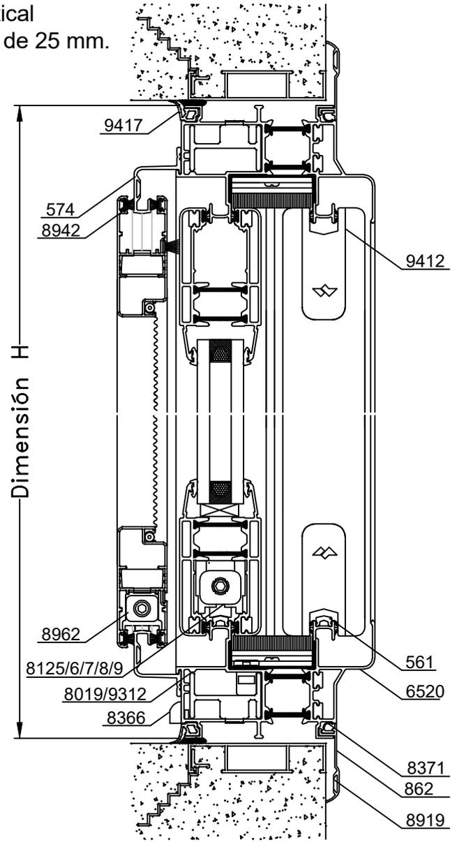
A-A Corte Horizontal con Poliamida de 25 mm.
